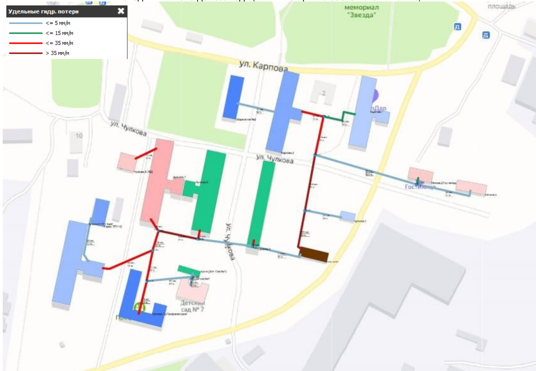
Рисунок 1.6.2.1 - Гидравлические расчеты участков тепловой сети Котельной №1
